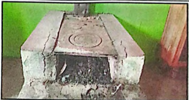
Foto 6: plancha pandeada y rota
